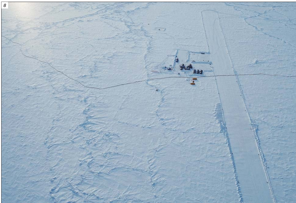
Аэродромы на ледовой базе «Барнео» 5-го (а), 9-го (б) и 14-го (в) апреля 2016 г. Каждая взлетно-посадочная «полоса» после ледового торошения при прохождении трещины строилась заново.
